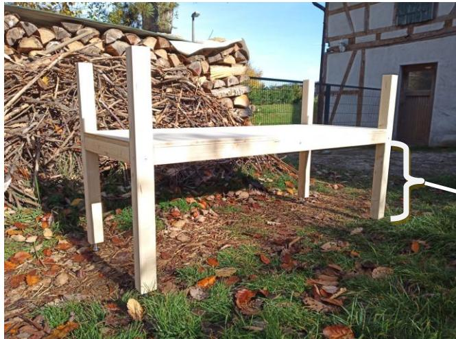
Abstand zwischen Unterkante obere Bodenplatte und Pfosten unten 44cm (abhängig von Boxenhöhe, empfohlen 32cm)
