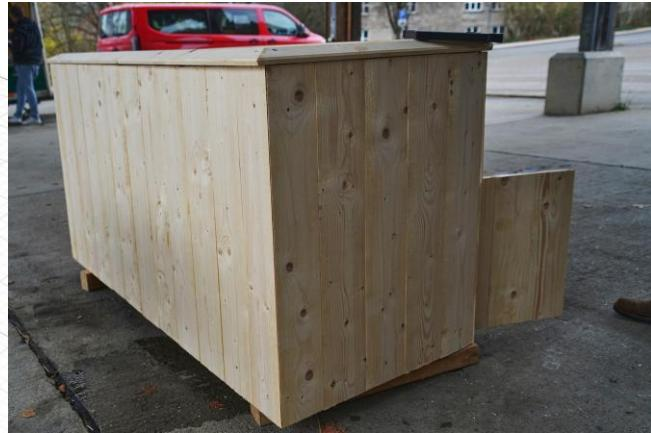
Nut- und Federhölzer auf Länge geschnitten: 83cm hoch (aus 4,2m Latten lassen sich 5 Bretter schneiden). Die untere Seite der Vertäfelung scharfkantig abschrägen (konstruktiver Holzschutz), sonst kann abtropfendes Wasser von unten her durch die Kapillarkräfte in das Holz gesogen werden und es schädigen. Oberhalb der Türen formen die Nut- und Federhölzer den Beet-Bereich, Hölzer auf 35cm Länge zuschneiden und wie die übrigen Hölzer verleimen und anschrauben.
