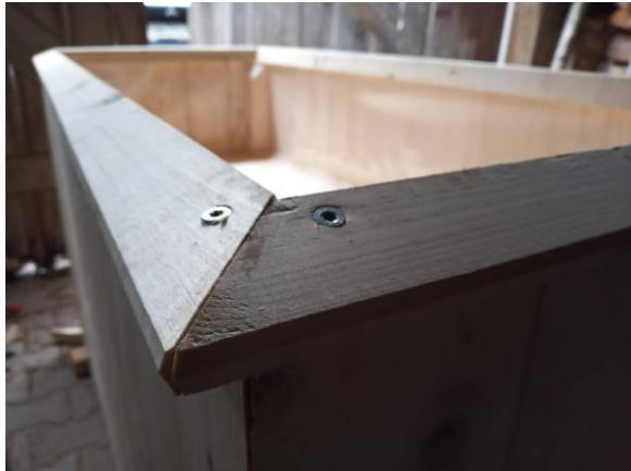
Die Abschluss-Leiste kann aus einem der Kanthölzer durch schräges Zersägen erzeugt werden.
